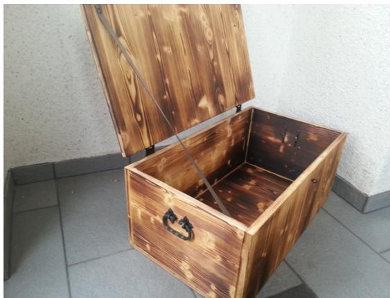
Die Transportkiste wird aus 19mm starken Dreischichtplatten zusammengebaut. Alle Teile werden maschinell zugeschnitten und gebohrt. Anschließend mit Holzdübel verbunden und verleimt. Die Kiste wird auf Wunsch geölt oder geflämmt und geölt. Die Scharniere und der Verschlussbügel werden mit 16mm Schrauben befestigt. Die Tragegriffe sind eine Reproduktion nach historischem Vorbild, aus Eisen rustikal schwarz handgeschmiedet und werden mit einer Eisenklammer von innen vernagelt.
